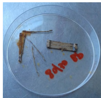
Fibre corrodibili, prova non superata
