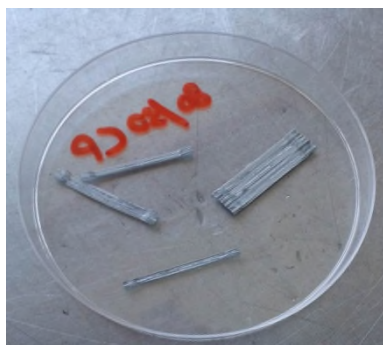
Fibre anticorrosione, prova superata
